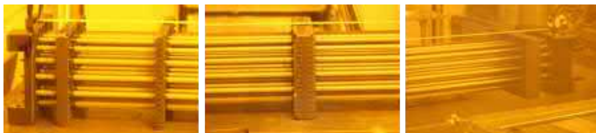
Рис. 10. Результаты визуальной инспекции силового каркаса ТВС-К
