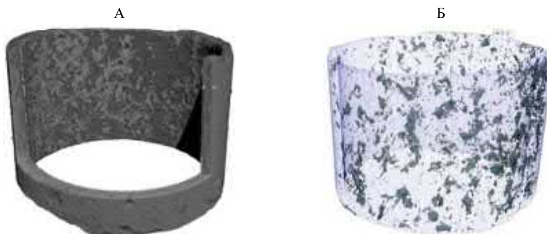
Рис. 10. Модель реконструкция по данным микротомографии (размер пикселя – 4,4 мкм) образца четырехслойной оболочки твэла из композиционных материалов SiC/SiC длиной 15 мм, внутренним диаметром 9,6 мм и наружным диаметром 10,7 мм: А – трехмерная реконструкция оболочки; Б – трехмерная реконструкция пористости, где поры выделены серым цветом
