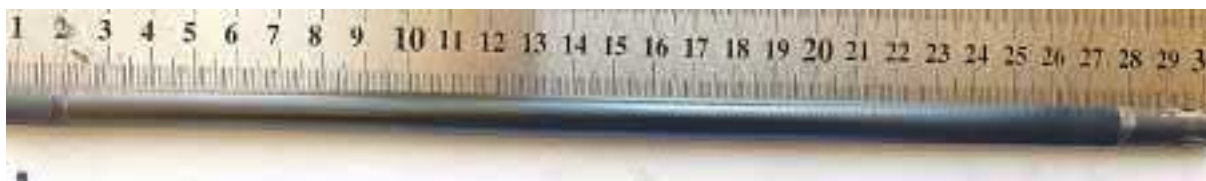
Рис. 5. Фотография внешнего вида графитового стержня (наружный диаметр 9,6 мм, длина 300 мкм) с монокристаллическим покрытием пироуглеродного SiC толщиной 320 мкм и длиной до 270 мм
