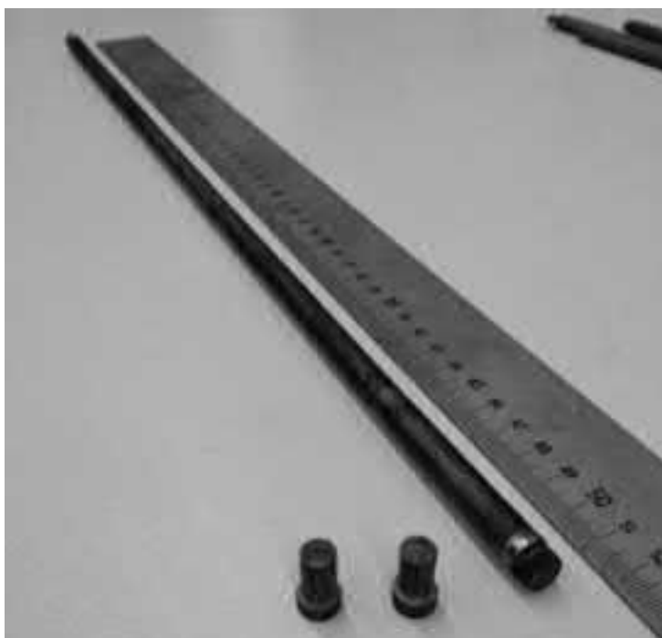
Рис. 4. Внешний вид герметизированного опытного твэла на основе карбида кремния длиной 500 мм и керамические концевые элементы
