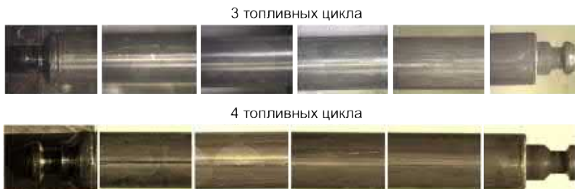
Рис. 2. Результаты визуальной инспекции оболочек твэлов
